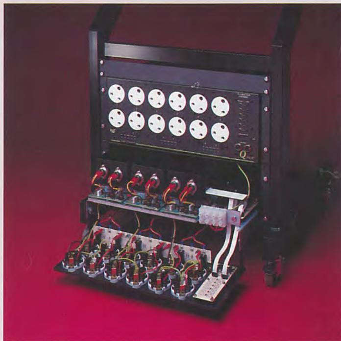
Un bloc de puissance gradateur de haute qualité, conçu spécialement pour fonctionner avec la Q12 et la Q24, mais également compatible avec les régies de lumières d'autres marques en 0-10V analogiques ou DMX512 pour un rapport qualité-prix très séduisant.
