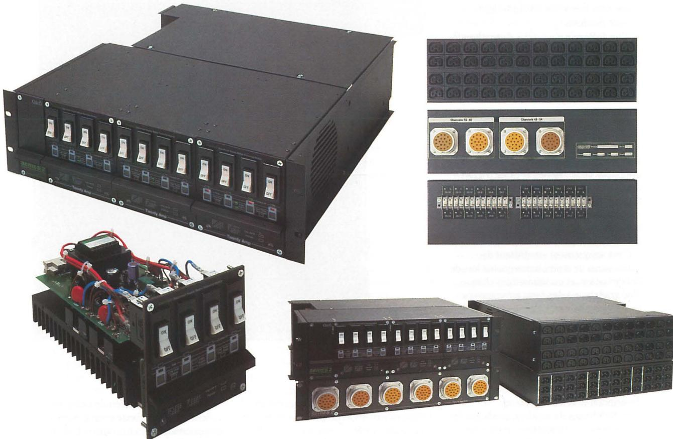
Le bloc gradateur de la "Series 2", est livré soit en version "Series 2 Ten", avec 10 A par canal en charge maximale, soit en version "Series 2 Twenty" avec 20 A par canal en charge maximale. Les deux versions, avec un choix de trois options différentes de sortie canal, peuvent être incorporées dans un système complet ou être utilisées de façon "autonome". Un système de barre omnibus sélectif permet de les utiliser soit sur des alimentations monophasées soit sur des alimentations triphasées.
