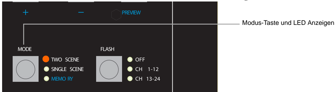
Abbildung 6: Modus-Taste LED Anzeige - Two Scene (Zwei-Szenen-Modus)
